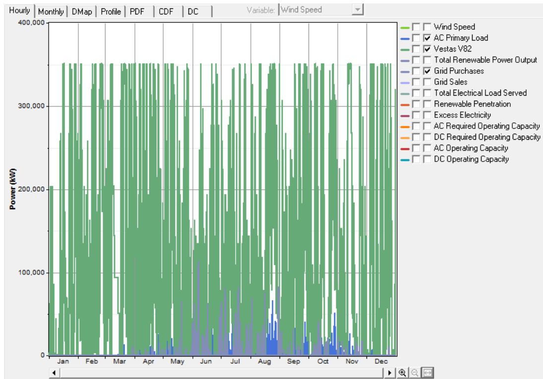
Εικόνα 66 Συγκεντρωτικό διάγραμμα στο οποίο εμφανίζεται η ενέργεια που παράγεται από τις ανεμογεννήτριες του συστήματος με πράσινο χρώμα, με γκρι χρώμα η ενέργεια που αγοράζεται από το διασυνδεδεμένο δίκτυο και τέλος με μπλε χρώμα η ενέργεια που απαιτείται από το σύστημα για όλους τους μήνες του χρόνου.
